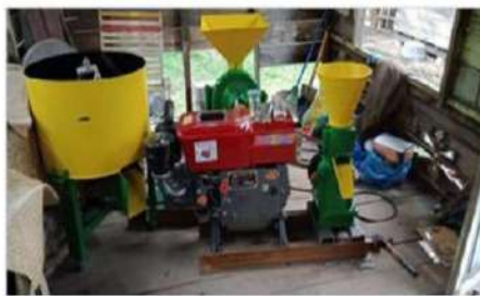
Gambar 2.5. Mesin multifungsi pengaduk, penepung, dan pelet
