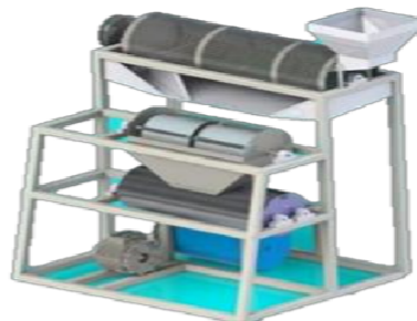
Gambar 2.1 desain mesin pengupas kacang
