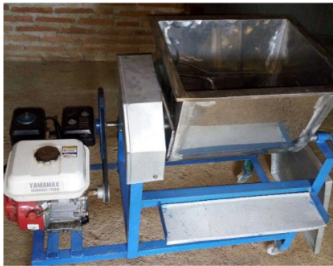
Gambar 2.1 Mesin Pengaduk Adonan Bakpia
