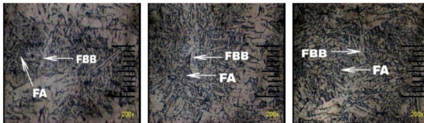
Gambar 4.3 Hasil struktur mikro daerah logam las (a) Arus 90 A, (b) Arus 100 A, (c) Arus 110 A
