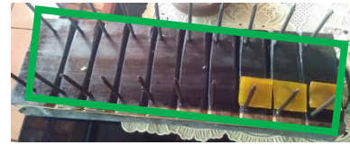
Gambar 4.10 Alat potong kayu yang digunakan untuk memotong krecek yang berbentuk persegi panjang menjadi bentuk persegi.
