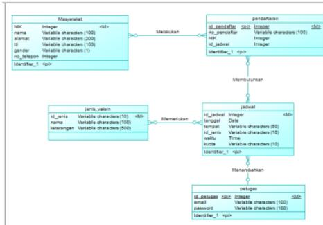
Gambar 9 Entity Relationship Diagram sistem penjadwalan
