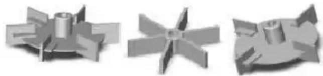
Gambar 2. 7 Pengaduk Turbin Pada Bagian Variasi
