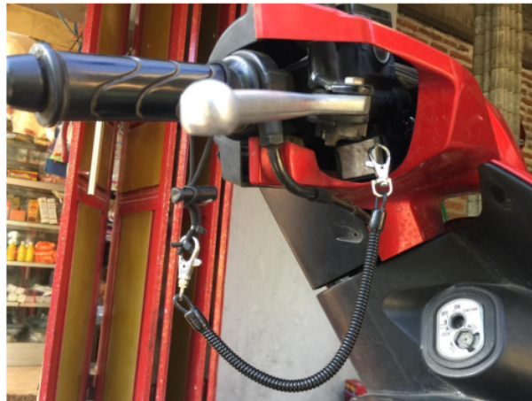
Lampiran 4. Penempatan emergency switch di stang kanan
