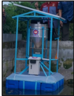
Gambar 7 Gambar alat peontar pakan ikan berbasis IoT
