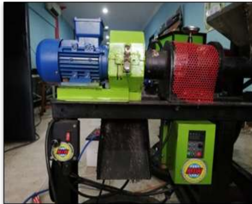
Gambar 8 Mesin pemanas Daya Motor (P) = 1,5 Hp x 0,746 = 1,119 kw
