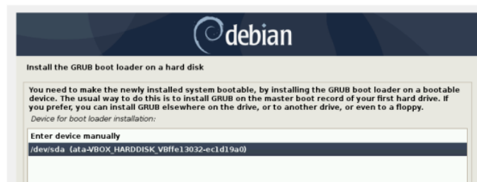
Gambar 4. 36. Konfigurasi GRUB boot loader
