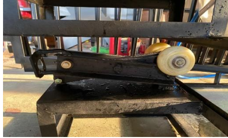
Gambar 4. 2 Motor Lift Pada Posisi Terendah
