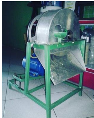
Gambar 1. 2 Mesin Pemotong Pisang Dan Singkong
