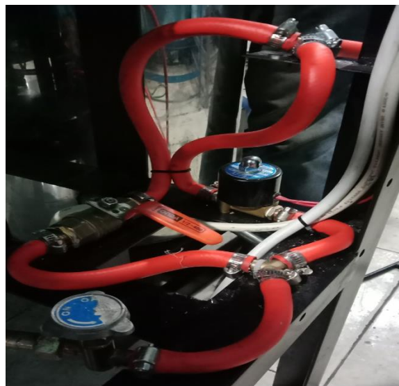
Gambar 6. Rangkaian sistem nyala api
