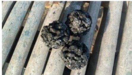
Gambar 4. Briket Setelah Dicetak
