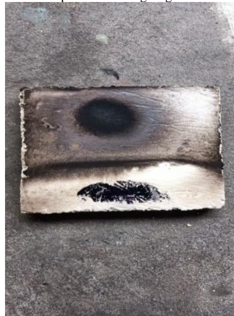
Gambar 4. Keramik alumina bagian dalam setelah dilakukan pembakaran
