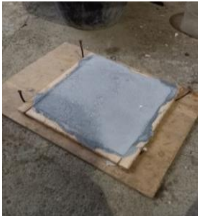
Gambar 2. Pencetakan semen alumina
