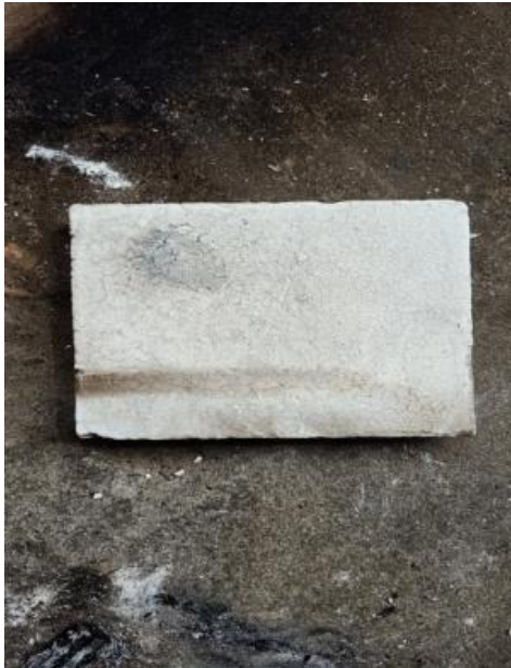
Gambar 5. Permukaan luar keramik alumina setelah dipanaskan
