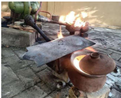
Gambar 2. Pelelehan limbah kaca dengan feldspar
