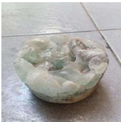
Gambar 3. Pelelehan limbah kaca dengan feldspar 10%
