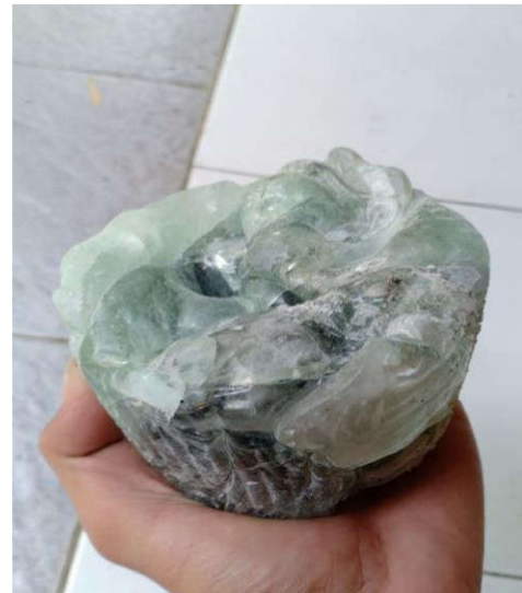
Gambar 4. Pelelehan limbah kaca dengan feldspar 20%
