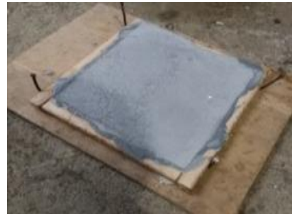
Gambar 2. Pencetakan semen alumina
