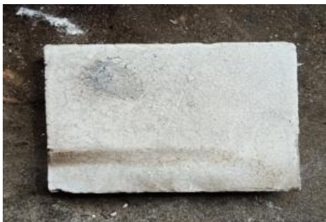
Gambar 5. Permukaan luar keramik alumina setelah dipanaskan
