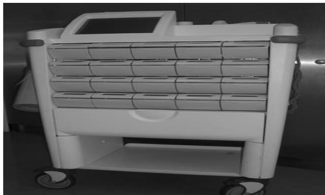
Gambar 4 : gambar troli obat elektronik, nama pasien ditampilkan pada layar kristal cair. dan Barcode scanner di atas troli.
