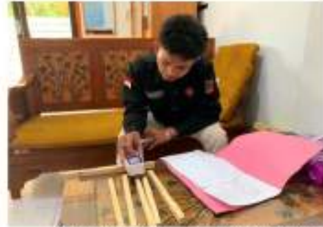
Gambar 4. 2 Pengukuran kekasaran permukaan menggunakan Surface Roughness Tester
