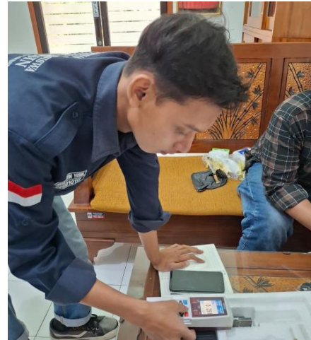
Gambar 4. 1 Pemotongan Bahan menggunakan Mesin Laser Cutting CNC Gambar 4. 2 Pengukuran Bahan menggunakan Alat Surface Roughness Tester
