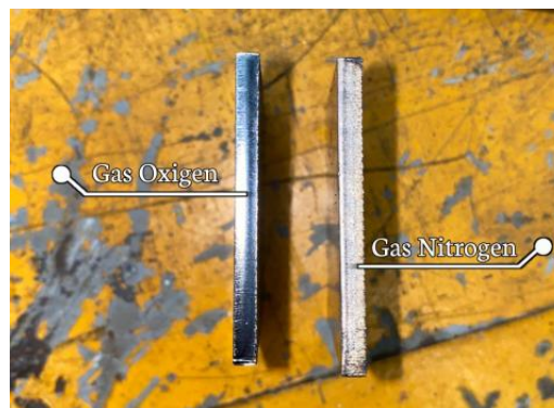
Gambar 4. 4 Hasil Pemotongan Pada Variasi Jenis Gas
