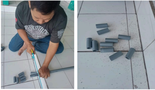
Gambar 3.4 Memotong paralon penyambung ketinggian (Sumber : Dokumen Pribadi 2024)
