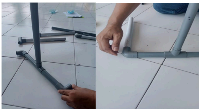
Gambar 3.8 Memasang kaki penyeimbang (Sumber : Dokumen pribadi 2024)
