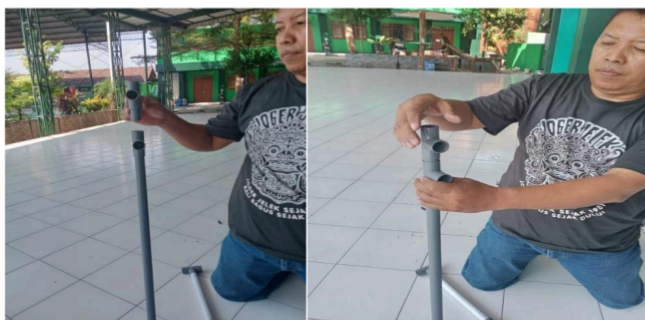
Gambar 3.11 Memasang paralon T untuk penambah ketinggian dan penempatan mistar paralon ( Sumber : Dokumen pribadi 2024)
