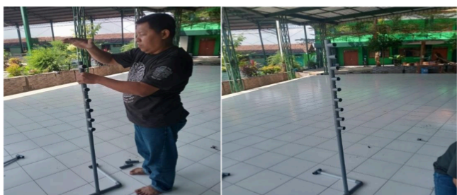
Gambar 3.12 Memasang paralon T untuk penambah ketinggian dan penempatan mistar paralon ( Sumber : Dokumen pribadi 2024)
