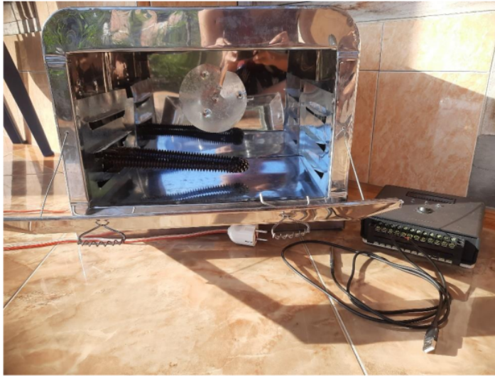
Gambar 4.1 Alat Pengering Maggot Berbasis IoT
