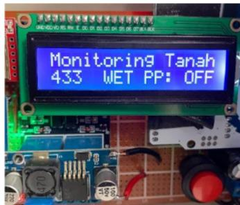
7. Selama proses penyiraman bawang merah dan sensor *moisture soil* tidak mendeteksi tanah kering maka pompa juga tidak akan menyiram bawang merah.
