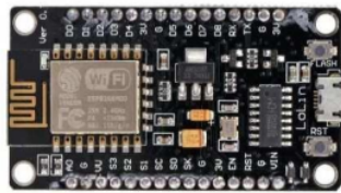
Gambar 2.1 Node MCU ESP8266
