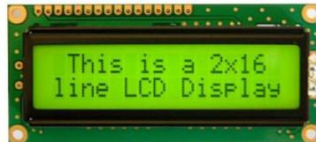
Gambar 2.7. LCD (*Liquid Crystal Display*) 16x 2
