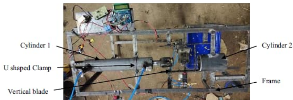
Gambar 2. 3 Rancang Bangun Mesin Pengupas Nanas Menggunakan Sistem Pneumatic Solenoid Valve
