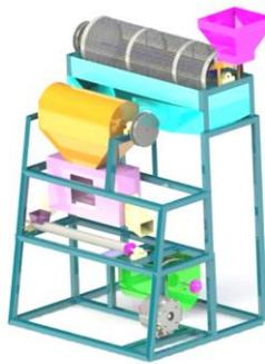
Gambar 3.16 Desain 3D Mesin Pengupas Kacang Tanah
