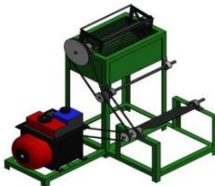
Gambar 2.3 Desain Kontruksi Mesin pengupas Kacang
