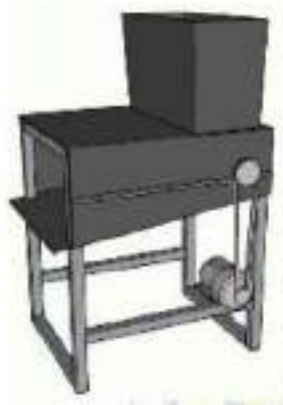
Gambar 2.2 Rangka Mesin Pengupas Kacang Tanah
