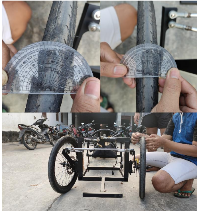
Gambar 4.3 Uji Coba Belokan dengan Radius 15°
