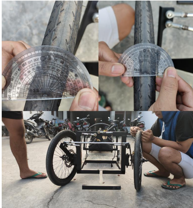
Gambar 4.4 Uji Coba Belokan dengan Radius 20°
