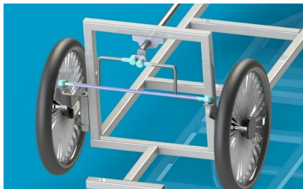
Gambar 3.6 Sistem Kemudi Tampak Depan
