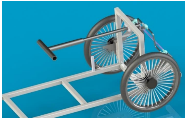
Gambar 3.4 Sistem Kemudi Tampak Samping
