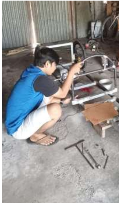
Proses pemasangan Rolbar
