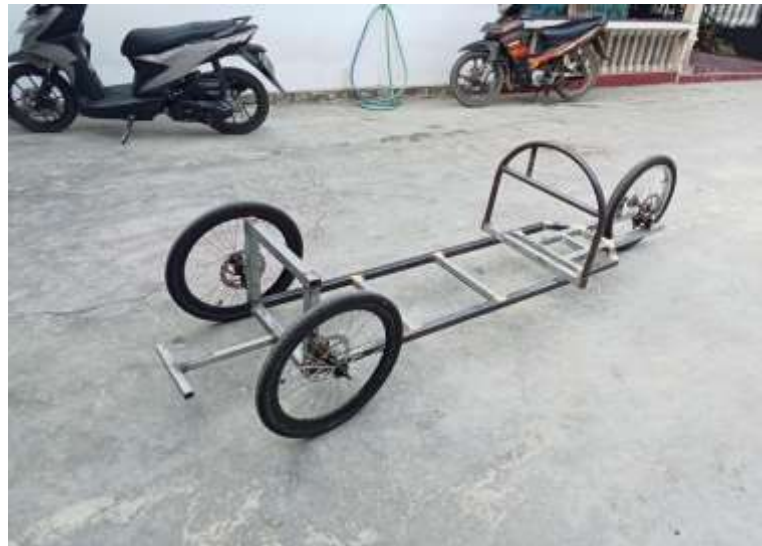
Gambar 4.1 Hasil Chassis Mobil Listrik
