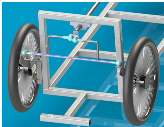
Gambar 3.4 Sistem Pengereman Prototype Mobil Listrik Tampak Depan
