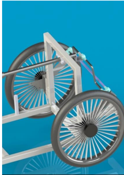
Gambar 3.5 Sistem Pengereman Prototype Mobil Listrik Tampak Samping Luar
