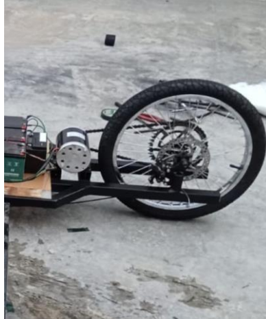
Gambar 4.5 Perancangan Pengereman Roda Belakang
