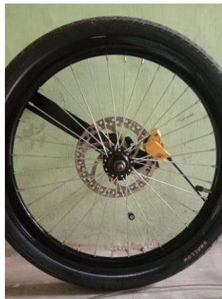
Gambar 4.3 Perancangan Pengereman Tampak Samping Luar
