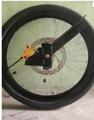
Gambar 4.4 Perancangan Pengereman Tampak Samping Dalam
